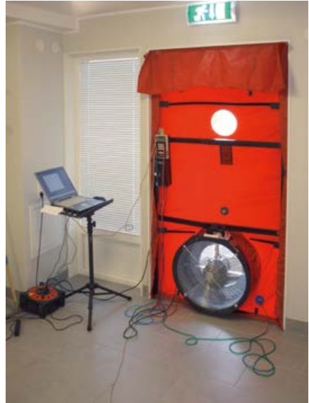
Ilmanvuotoluvun mittausta oveen asennetun laitteiston avulla
